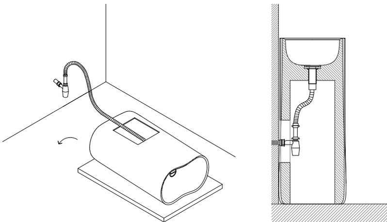
La posa non necessita di silicone, il lavabo deve essere removibile per ispezionare
