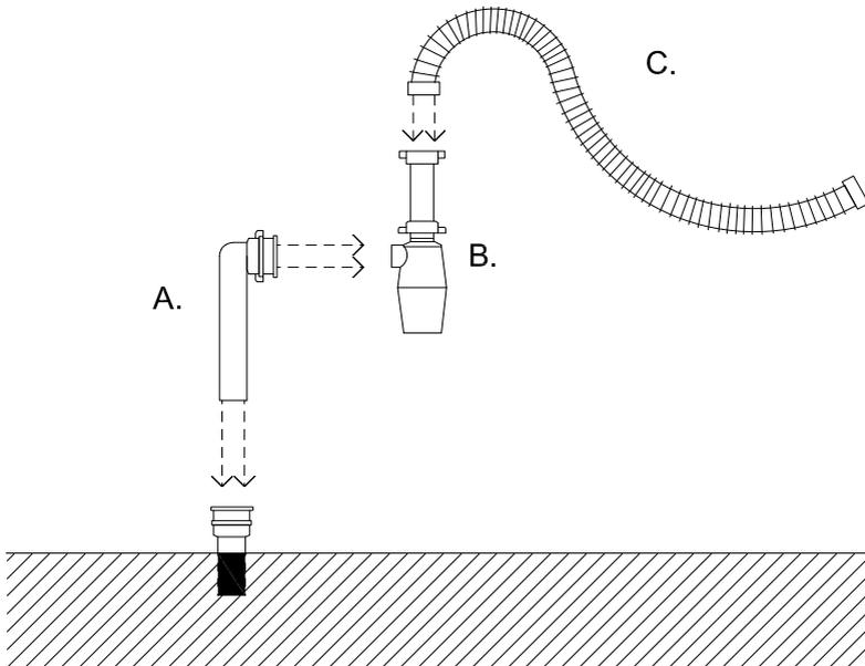
Comporre le componenti dello scarico fornite, connettendole alla braga a pavimento.
