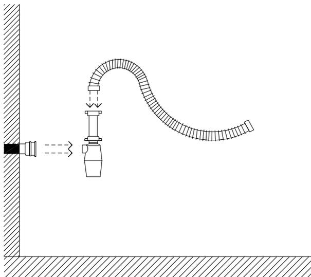
Comporre le componenti dello scarico fornite, connettendole allo scarico a parete.
