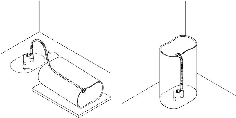
La posa non necessita di silicone, il lavabo deve essere removibile per ispezionare l'impianto di scarico in caso di necessità.
