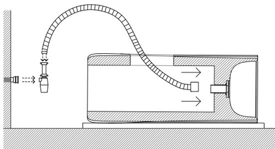
Il lavabo presenta un foro sulla parte posteriore; inserire il tubo flessibile all'interno.
